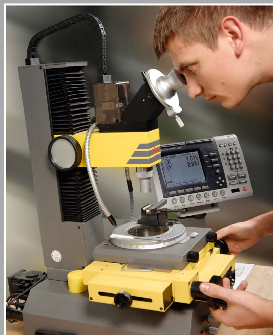
Endkontrolle unter 100facher Vergrößerung
